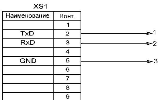
Рисунок И.1 – Схема кабеля КРАУ4.841.020 для подключения компьютера к БИЗ-002
